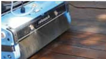
Der Schmutz des Holzrostes wird im integrierten Auffangbehälter gesammelt.
