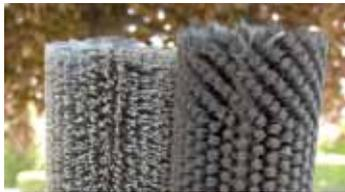
Das warme Wasser aus den Düsen befeuchtet das Holz. Die beiden gegenläufige Zylinderbürsten erzielen optimale Ergebnisse.
