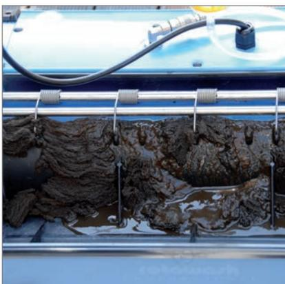
Der Schmutz des Holzrostes wird im integrierten Auffangbehälter gesammelt.
